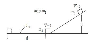
19. Un bloque se desliza hacia abajo por una vía curva sin fricción y luego hacia arriba de un plano inclinado, como lo muestra la figura. El coeficiente de fricción cinético entre el bloque y el plano inclinado es  $\mu_k$ . Hallar la altura máxima alcanzada por el bloque.
