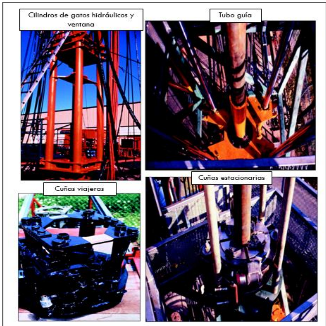
Figura 26. Componentes de la unidad de Snubbing
