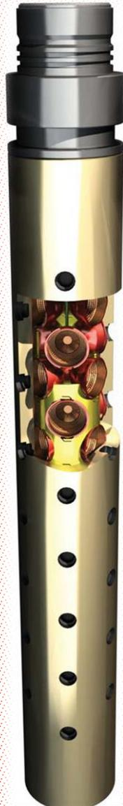
Consiste en la perforación de agujeros con explosivos a través de la tubería de revestimiento de acero, el cemento y la roca de formación. El cañoneo es el único modo de realizar túneles que establezcan enlaces entre el yacimiento de crudo o gas y el pozo revestido que va hasta la superficie, por lo que esta operación es la clave para el éxito de la producción económica del crudo y gas, la productividad del pozo a largo plazo y la recuperación eficiente de los hidrocarburos.
