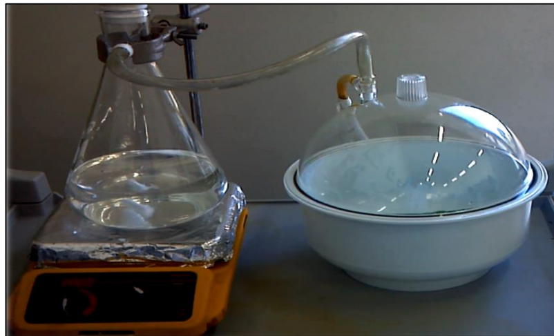
Figura 1. Plancha, Erlenmeyer y Desecador
