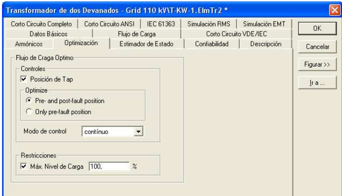
Figura 3.1.5.2.- Datos de optimización del Transformador T-110/10-60MVA.
