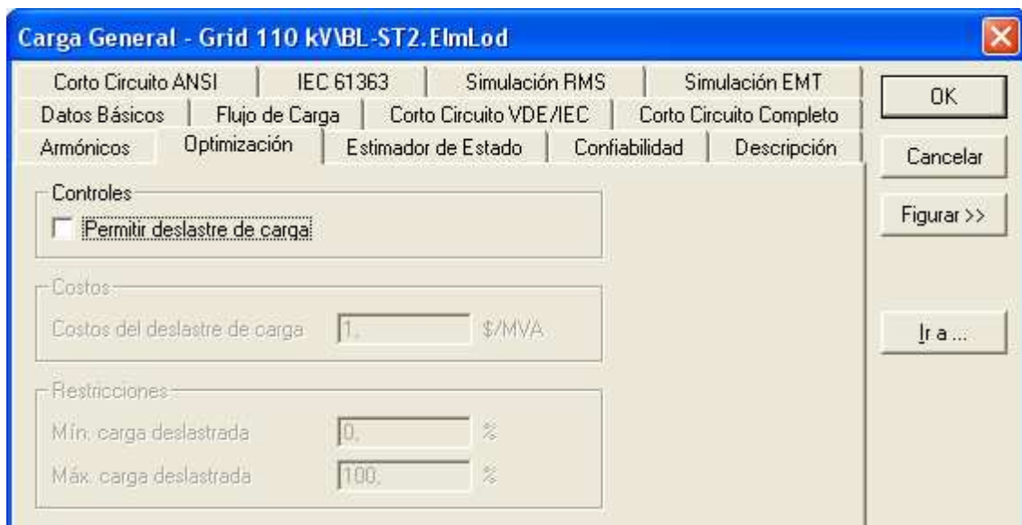
Figura 3.1.10.3.- Datos de Optimización de una Carga General
