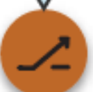
Interruptor o apagador
