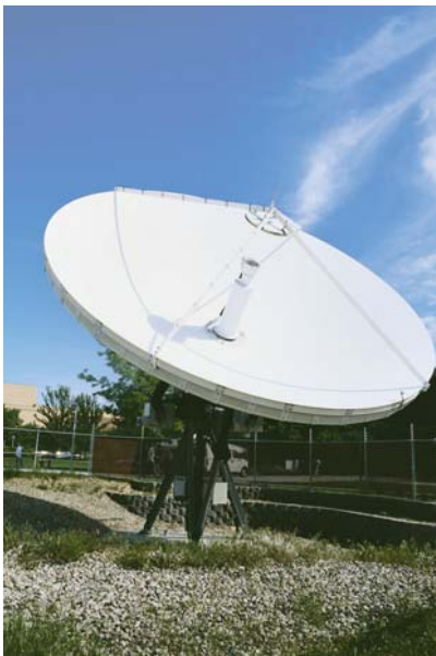
Una antena de disco refleja señales al foco de un paraboloide.
