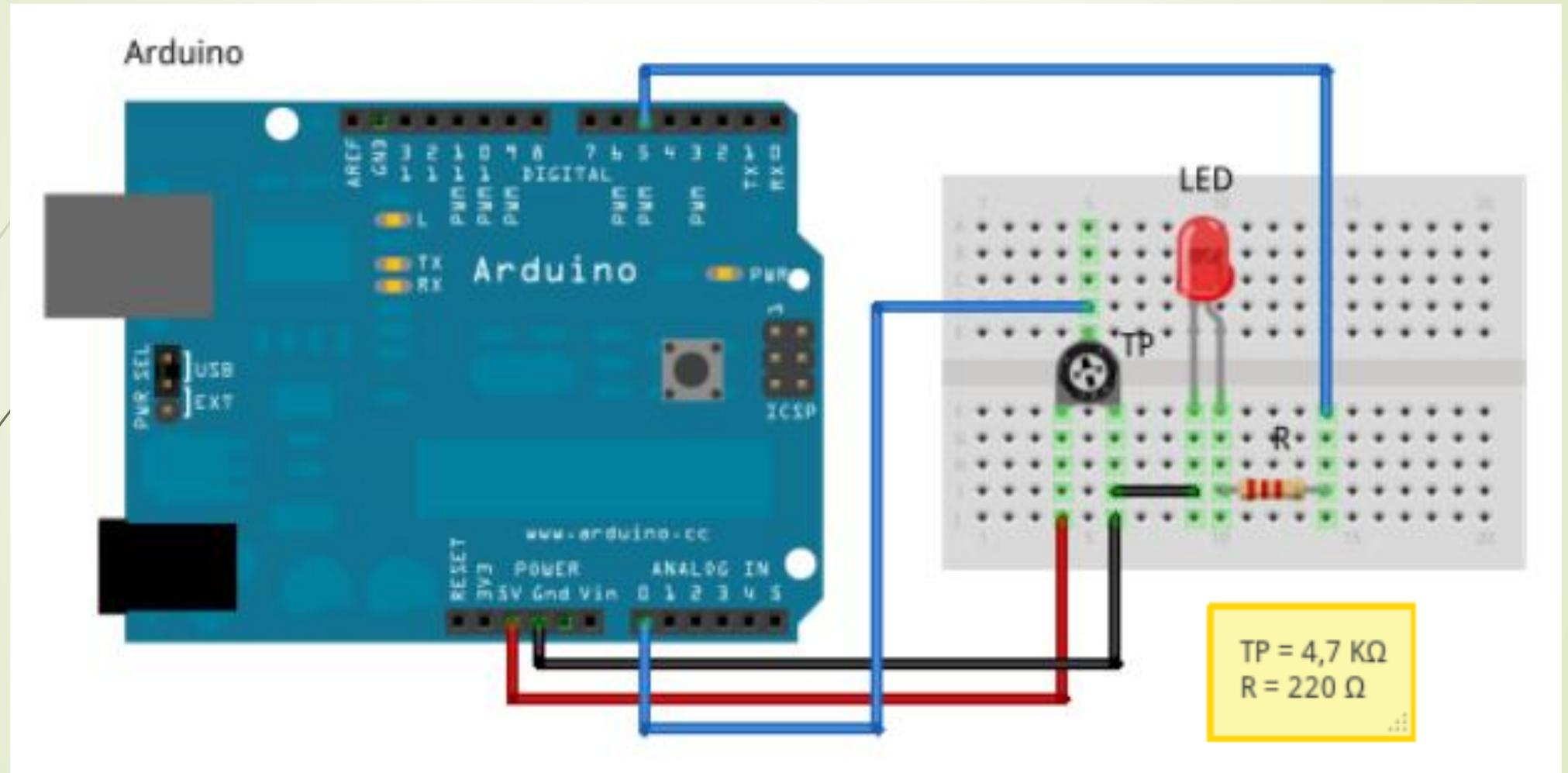
Usando el potenciómetro y uno de los pines de conversor A/D de Arduino es posible leer valores de 0 a 1024.
