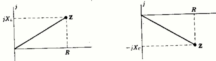
Fig. 5-4. Diagramas de impedancia
