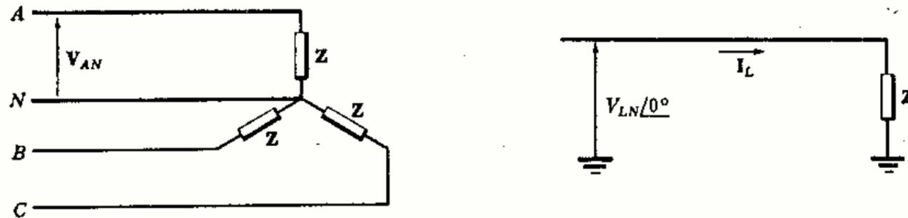
Fig. 14-10. Circuito monofásico equivalente
