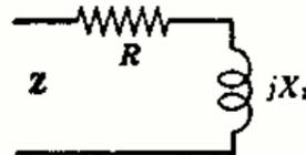
En la hipótesis de que la impedancia del circuito se reduzca a una resistencia en serie con una reactancia inductiva.
