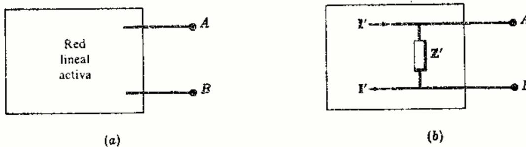
Fig. 11-5. Circuito equivalente de Norton
