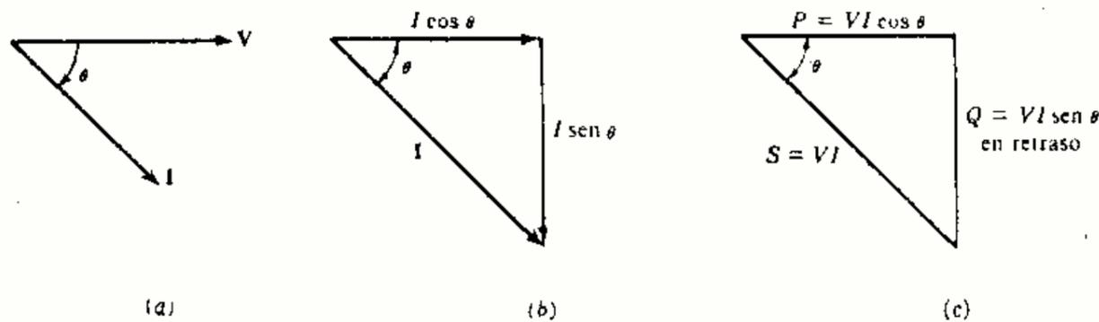
Fig. 7-6. Triángulo de potencias: Carga inductiva
