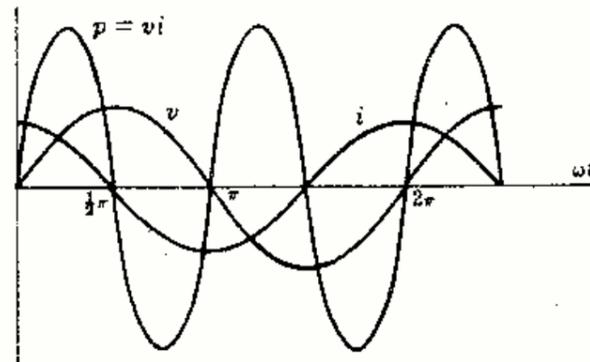
Fig. 7-3. Circuito de un condensador puro  $C$
