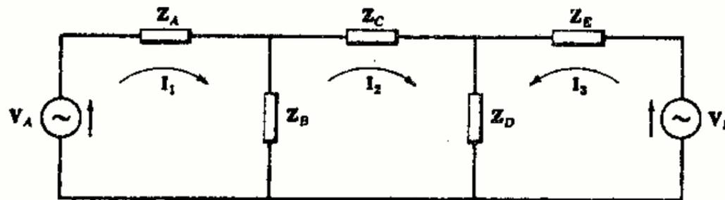
Fig. 9-1. Corrientes de malla en un circuito
