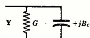
En la hipótesis de que la admitancia del circuito se reduzca a una conductancia en paralelo con una susceptancia capacitiva.
