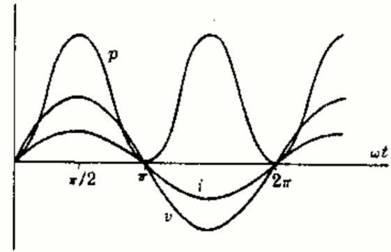
Fig. 7-4. Circuito de una resistencia pura  $R$
