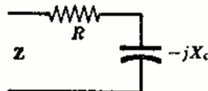
En la hipótesis de que la impedancia del circuito se reduzca a una resistencia en serie con una reactancia capacitiva.
