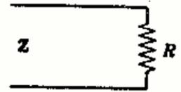
En la hipótesis de que la impedancia del circuito se reduzca a una resistencia pura  $R$  (ohmios).
