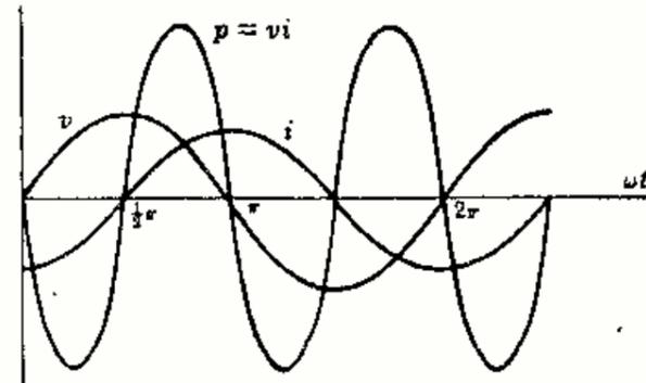
Fig. 7-2. Circuito de una bobina pura  $L$
