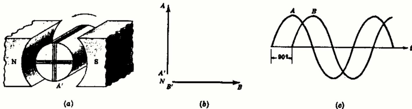
Fig. 14-1. Sistema bifásico
