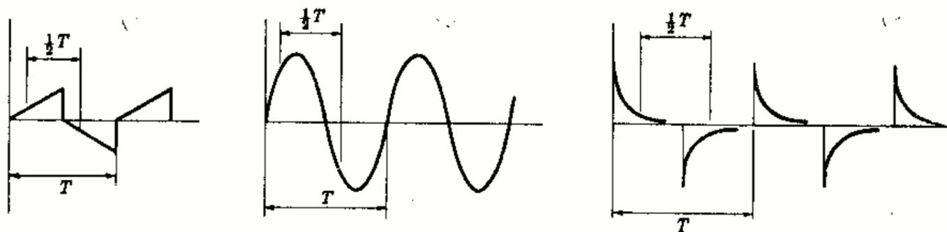
Fig. 2-2. Ondas de semiperiodo simétrico
