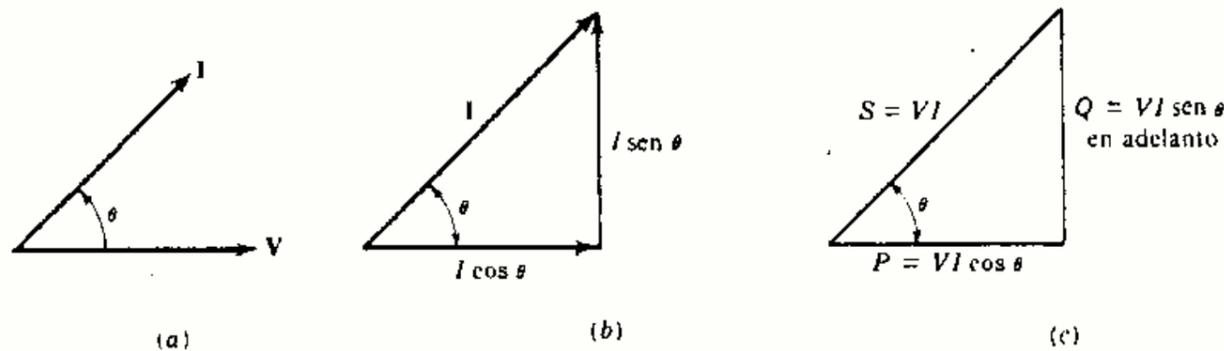
Fig. 7-7. Triángulo de potencias: Carga capacitiva
