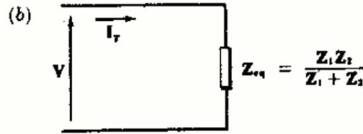
Fig. 6-7. Circuito paralelo de dos ramas
