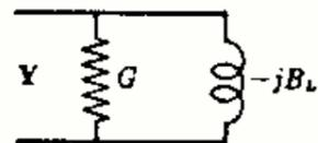
En la hipótesis de que la admitancia del circuito se reduzca a una conductancia en paralelo con una susceptancia inductiva.
