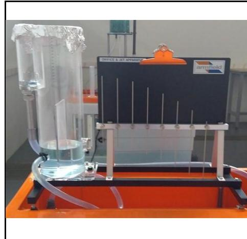
2. F1-17 Descarga por orificio y trayectoria (2 orificios)
