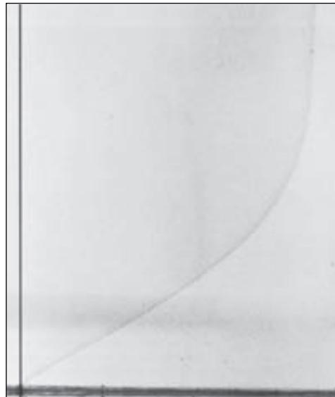
mente se verifica en la superficie de la placa, y el aumento suave en la velocidad del flujo con el aumento de la distancia de la placa verifica que el flujo, de hecho, es laminar.
