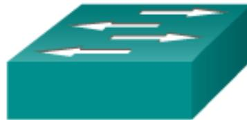
Un switch de almacenamiento y envío recibe la trama completa y calcula la CRC. Si la CRC es válida, el switch busca la dirección de destino, la cual determina la interfaz de salida. Entonces, se envía la trama por el puerto correcto.
