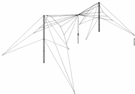
Dipolo horizontal de banda ancha, omnidireccional, 3 a 12 MHz. Torres de 22 metros en un área de 66 por 38 metros. Ganancia de 5dBi o superior.
