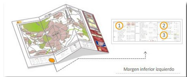
La leyenda se divide en tres columnas: [1] Lista de elementos lineales como carreteras, ferrocarriles, límites, construcciones, etc. [2] Lista de símbolos puntuales (vértice geodésico, cementerio, castillo, pozo, mina, etc.). [3] Lista de usos del suelo (monte arbolado, viña, olivar, regadío, etc.).
