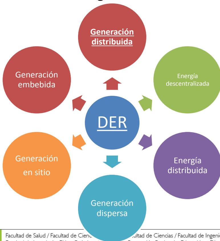
DER: son tecnologías de generación de energía a pequeña escala (por lo general en el rango de 1 kW a 10,000 kW), utilizadas como una alternativa o mejora del sistema de energía eléctrica tradicional.
