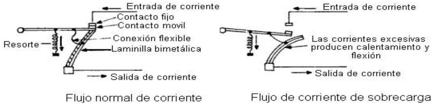
Figura 1.18 Acción del interruptor con disparo térmico.
