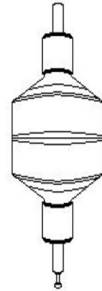
Figura 1.5 Fusible de vacío.
