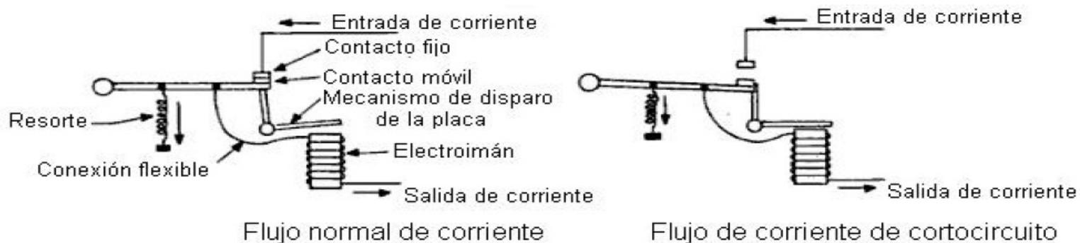
Figura 1.19 Acción del interruptor con disparo magnético.
